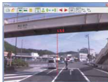
▲ 歩道橋施設の高さ計測
