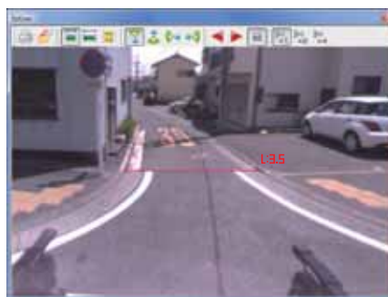
▲ 道路幅員の計測
